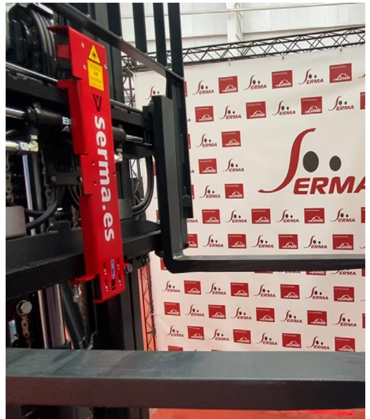
**LIZZARD Target:** Sistema de asistencia láser para enfocar los porta cargas.
