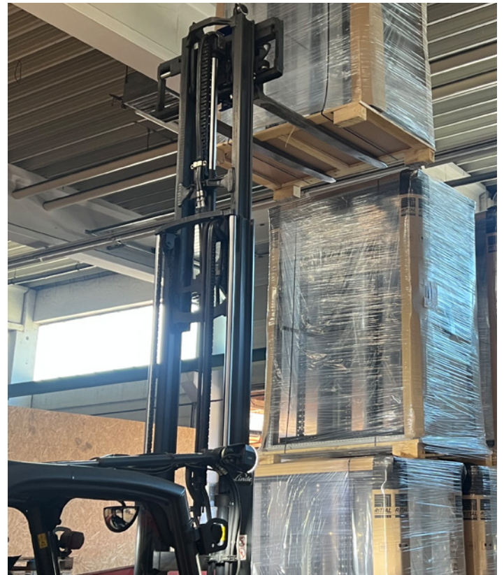
LIZZARD Cam: Kameraassistanssystem för säker upptagning av lastbärare.
